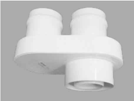
Моноблочный адаптер типа TWIN предназначен для конденсационных котлов EcoCondens Integra II Plus служит для перехода с коаксиальной системы дымоудаления 60/100 мм на две отдельные трубы диаметром 80 мм
