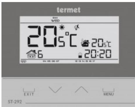
Комнатный регулятор температуры TERMET ST-292 V32 это программируемый, недельный регулятор с собственным батарейным питанием, позволяющий очень несложным и эффективным способом управлять температурой в помещениях.
